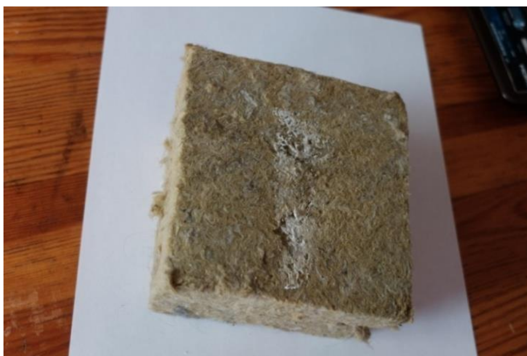
Рис.11 Биоповреждение каменной ваты плесневыми грибами через две недели просушки после проведения эксперимента на водопоглощение.
