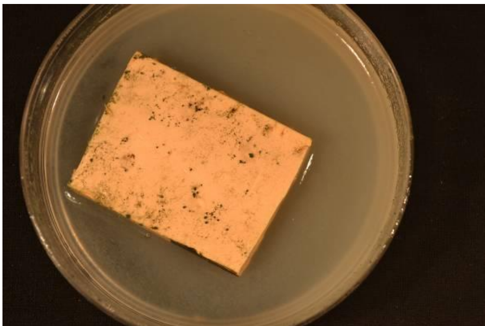
Рис. 3. Блок материала "Пеноплэкс" после продолжительного контакта с газоном плесневых грибов, перенесенный на чистую среду Чапека (переход грибов с загрязненной поверхности материала на питательную среду не происходит).
